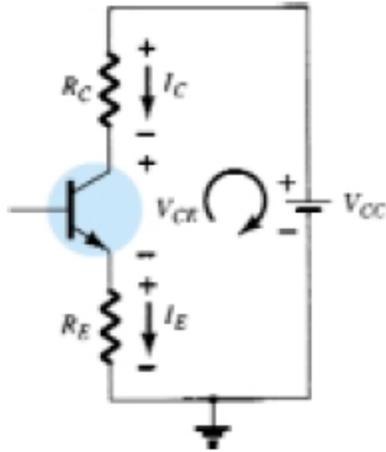
Fig. 13: Collector–emitter loop.
