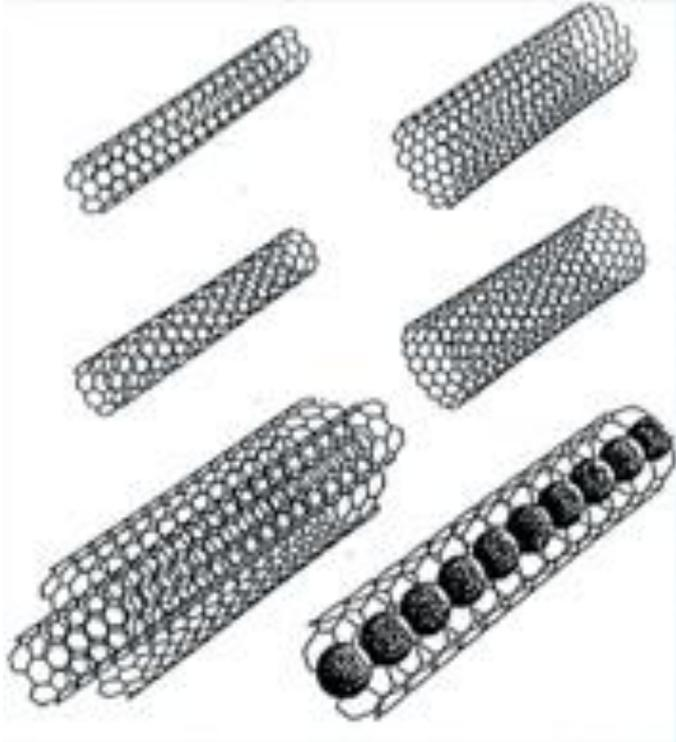
يتم إنتاج أنابيب الكربون النانوية بعدة تقنيات منها، التفريغ القوسي، الكحت الليزري، الترسيب بواسطة أول أكسيد الكربون ذي الضغط العالي، والترسيب بواسطة البخار الكيميائي.
