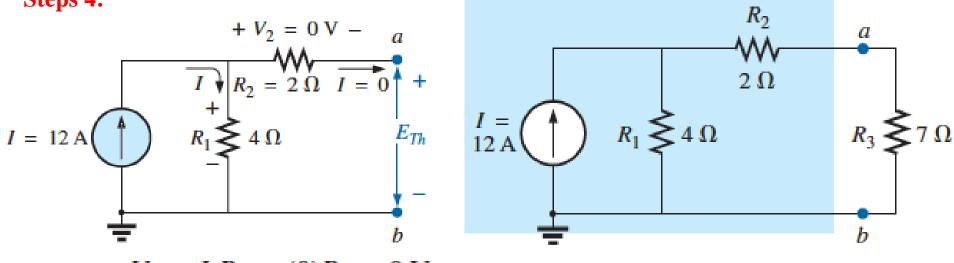
$V_2 = I_2 R_2 = (0) R_2 = 0 V$
